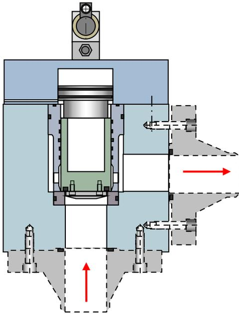
Dieses robuste dichtschießende Ventil wird für Anwendungen mit hoher Schalthäufigkeit wie zum Beispiel als Automatikventil eingesetzt. Das ölhydraulische Vorsteuersystem ermöglicht sehr kurze Schaltzeiten und einen Entfall von Vorsteuerfiltern. Die Einstellung der Schaltzeiten erfolgt auf der ölhydraulischen Seite. Zwei separate Dichtungssysteme und eine Entlüftungsbohrung verhindert die Vermischung von Steuer und Betriebsmedium und lässt Undichtigkeiten sofort erkennen.
