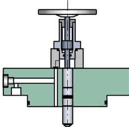
**Absperrventil mit Servounterstützung**
