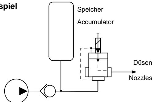
**Absperrventil mit elektro- hochdruckpneumatischer Vorsteuerung - fail safe**
