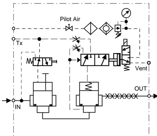
Beispiel eines elektrisch betätigten Pumpen Bypassventils mit mehrstufiger Entlastungsdüse und Handabsperrenteil mit Verriegelungsspindel.
