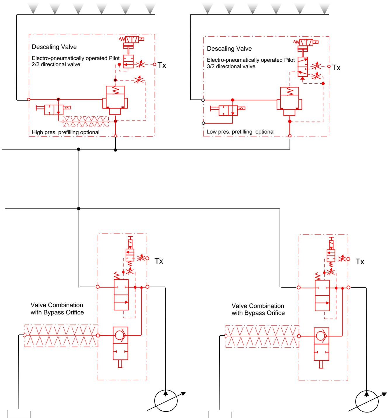
Beispiel für eine typische Anwendung. Rot dargestellte Komponenten stellen HL Hydraulik GmbH Produkte dar.
